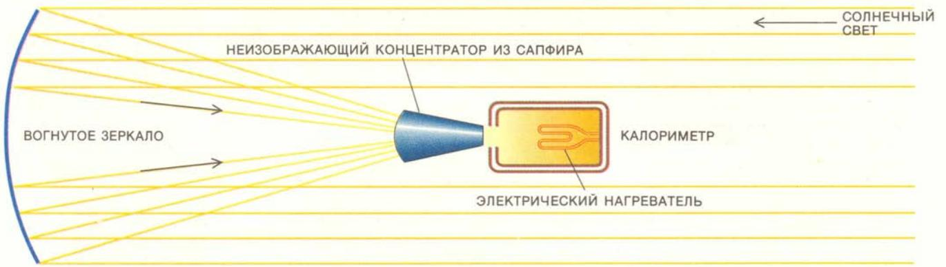
ЧТОБЫ ИЗМЕРИТЬ ВЫСОКУЮ ИНТЕНСИВНОСТЬ солнечного света, его пропускают через сапфировый концентратор в термососуд с жидкостью (калориметр). Регистрируется разность температур жидкости до того, как солнце «включено», и после того, как оно «выключено». Для кали-
