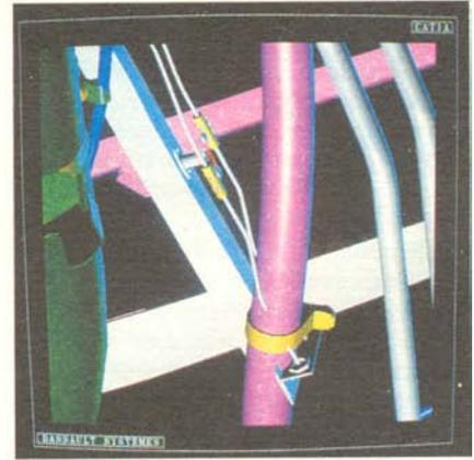
**ТРЕХМЕРНОЕ ПРОЕКТИРОВАНИЕ** позволяет компании Boeing моделировать сборку 130 тыс. уникальных деталей в новом реактивном самолете «777». Благодаря этому конструкторы могут заранее увидеть, не мешают ли друг другу багажное отделение, система обнаружения дыма (*тонкие трубки*) и гидравлическая линия (*вверху*). Фотография представлена компанией Boeing.
